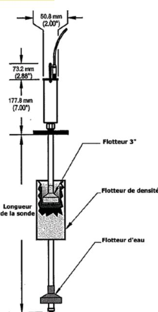
Le système de gestion de carburant de la série Colibri ou TS5 a la capacité de contrôler en permanence la densité du carburant stocké dans les cuves aériennes et enterrées.
